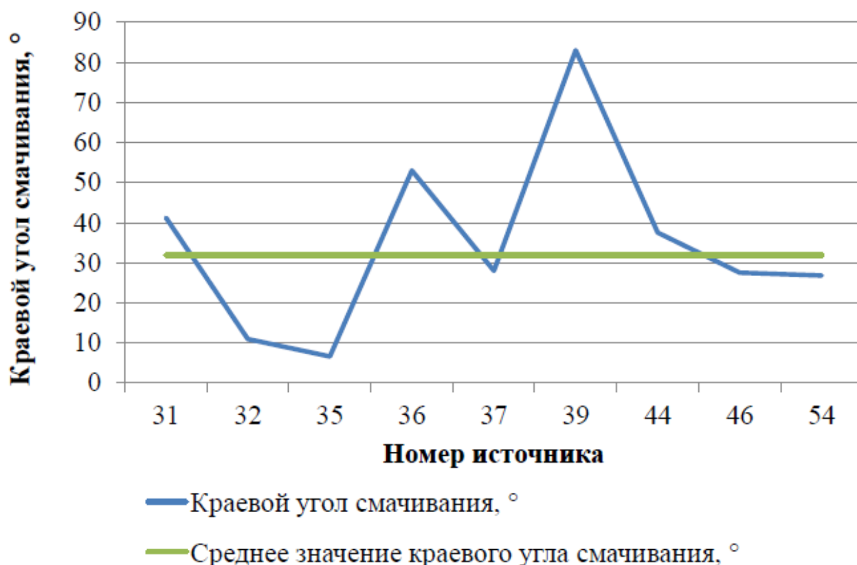
Рисунок 1.4 – Значения краевого угла смачивания пылеподавляющих растворов, указанные в различных статьях
