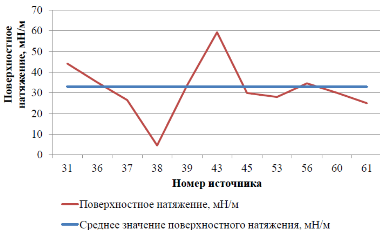
Рисунок 1.3 – Значения поверхностного натяжения пылеподавляющих растворов, указанные в различных статьях
